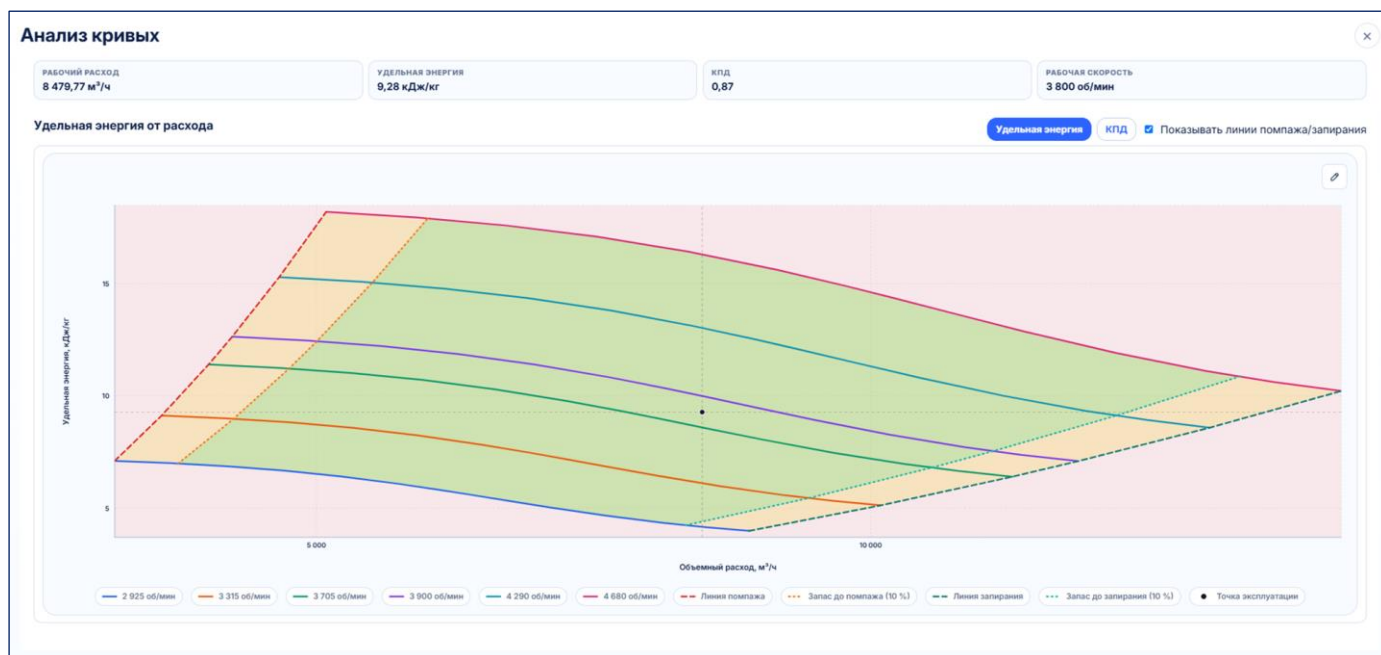
Рисунок 107. Анализ эксплуатационной диаграммы компрессора
