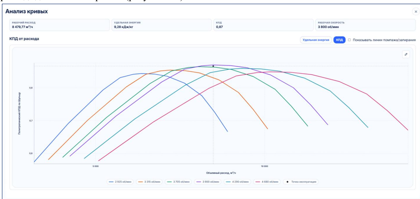
Рисунок 108. Анализ КПД компрессора по характеристическим кривым
